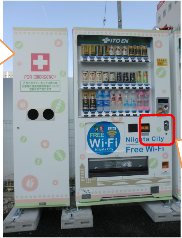
①災害支援自動販売機 (バッテリーの操作による貯蔵飲料提供)
